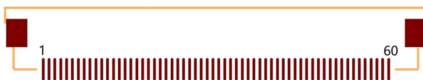
LVDS_60pin 双面接触 0.5mm 间距 FPC 插座
