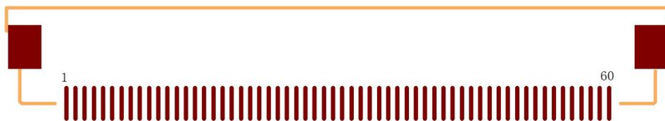
【LVDS 显示屏接口定义】 60PIN 下接触 0.5mm 间距
