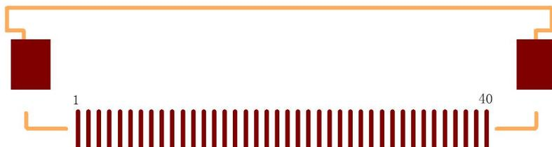
【LVDS 显示屏接口定义】40PIN 双面接触 0.5mm 间距
