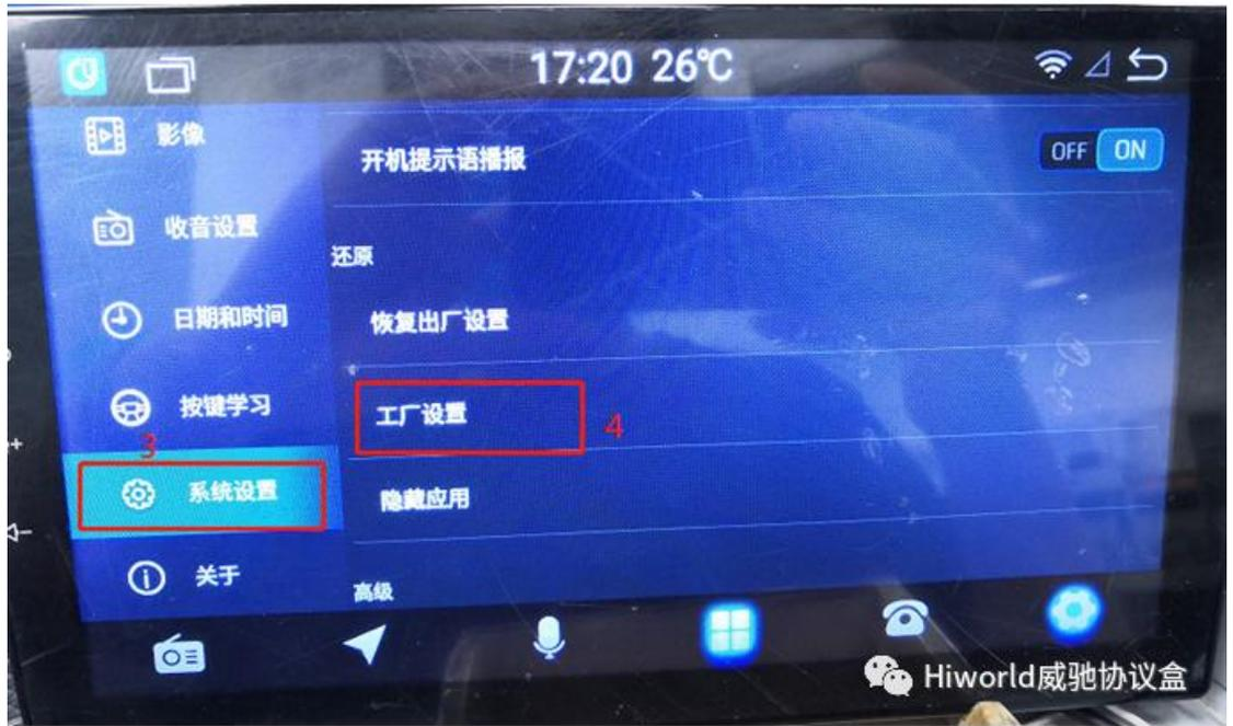
4. 点击“工厂设置”，然后输入工厂密码 888888，进到选车型界面
