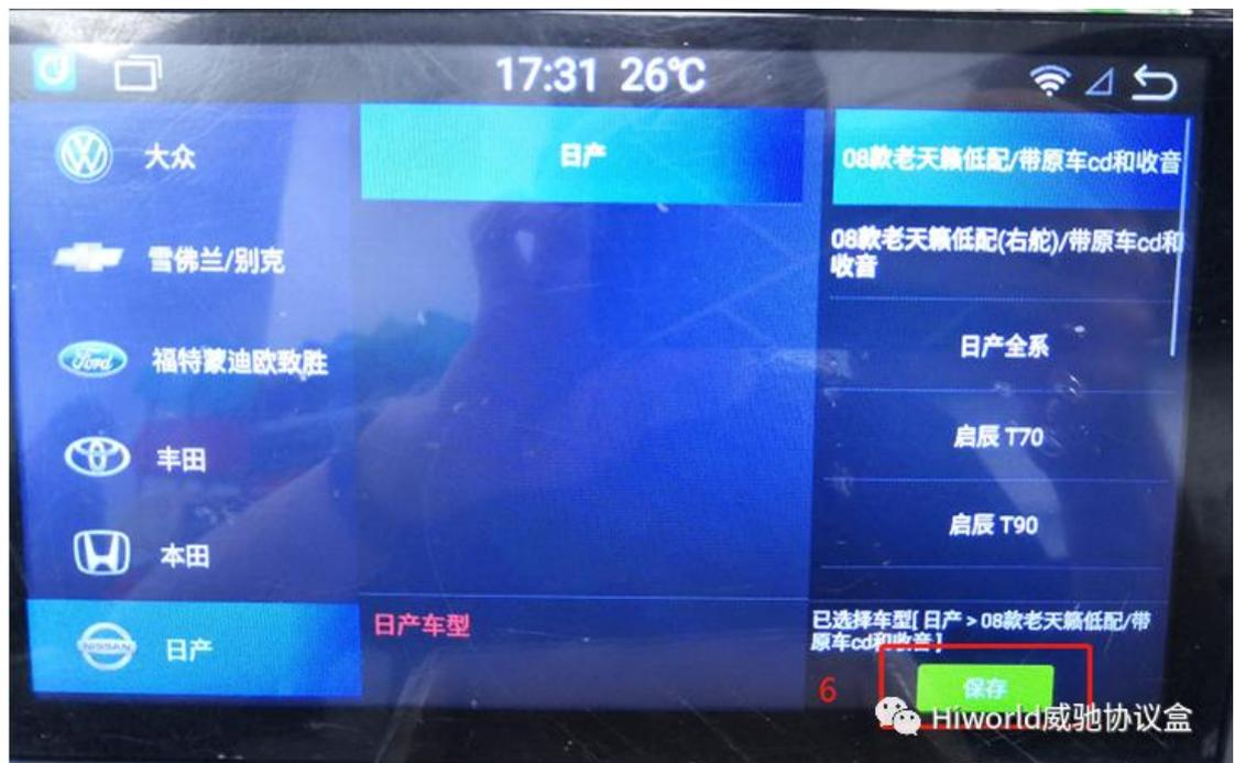
7. 保存车型后，会自动跳回设置界面，点击“系统设置”，找到“重启”，点击重启等待主机后重启就行。
