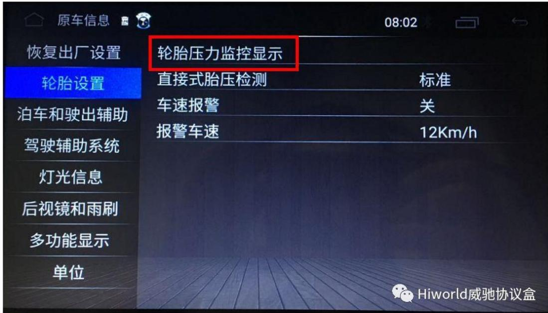
4. 点击轮胎压力监控显示，弹出提示后点确定即可清除胎压。
