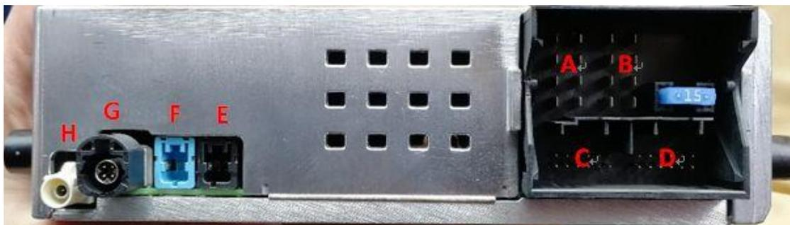
说明：A 为喇叭线端子；B 为电源，ACC，灯光，方控线端子；C 为按键面板 360 全景线端子；D 为按键面板端子；E 为 USB1；F 为 USB2；G 与改装无关，不接；H 为收音天线。
