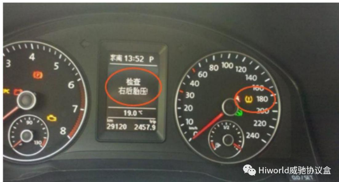
将轮胎修复并打回正常气压之后，安装直接式胎压的车辆胎压报警灯在点火行驶几分钟后会自动消失；而安装间接式胎压的车辆则需要用户手动消除。
