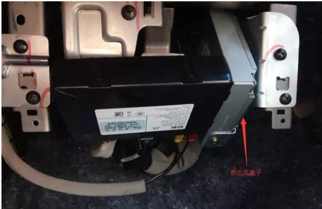
3) 可以看到此网关端子上有蓝色与粉色两根线，蓝色接网关线红色，粉色接网关线黑色。
