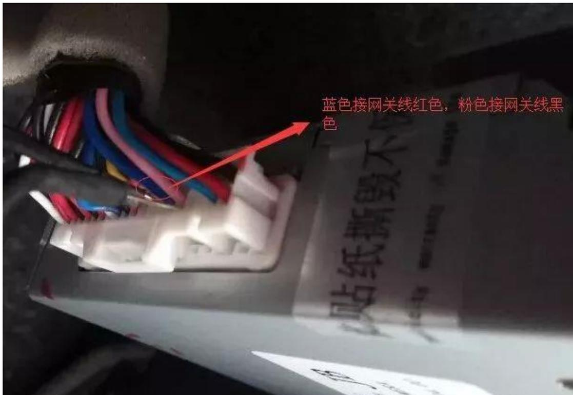
4) 盒子接线图示如下，全部接好后，把盒子插至原车 OBD 接口，启动车辆连接 APP 后即可正常使用。
