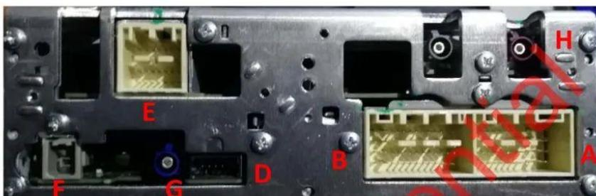
说明：A 为电源、ACC、协议端子；B 为后视、方控、喇叭端子；D 为 USB 接口；E 为后视镜按键检测；F 为收音天线；G 为 GPS 天线；H 为 4G 天线；
