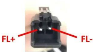
小喇叭端子图（线材做对插头）
