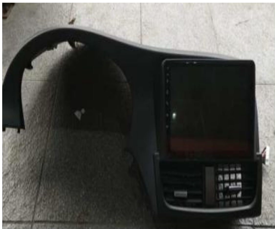
第 21 步大屏导航装在大框上正面效果图
