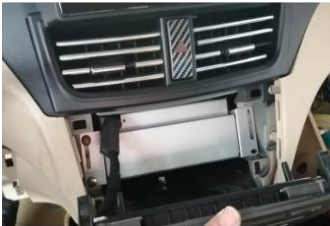
第 23 步在装主机，扣上空调面板
