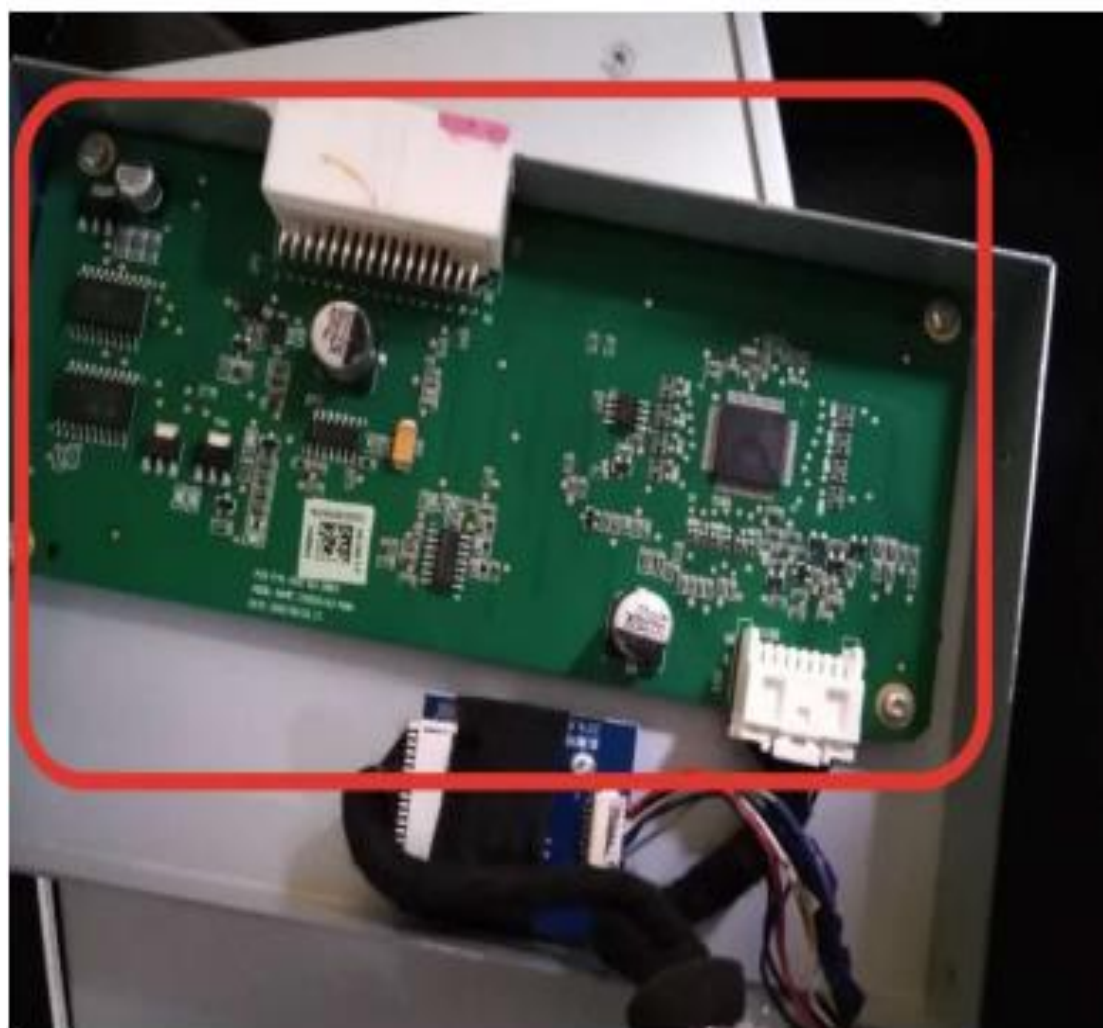
第 10 步原车空板拆出
