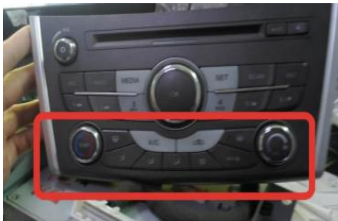
第 13 步空调面板线没插到位，只有加减风有作用！
