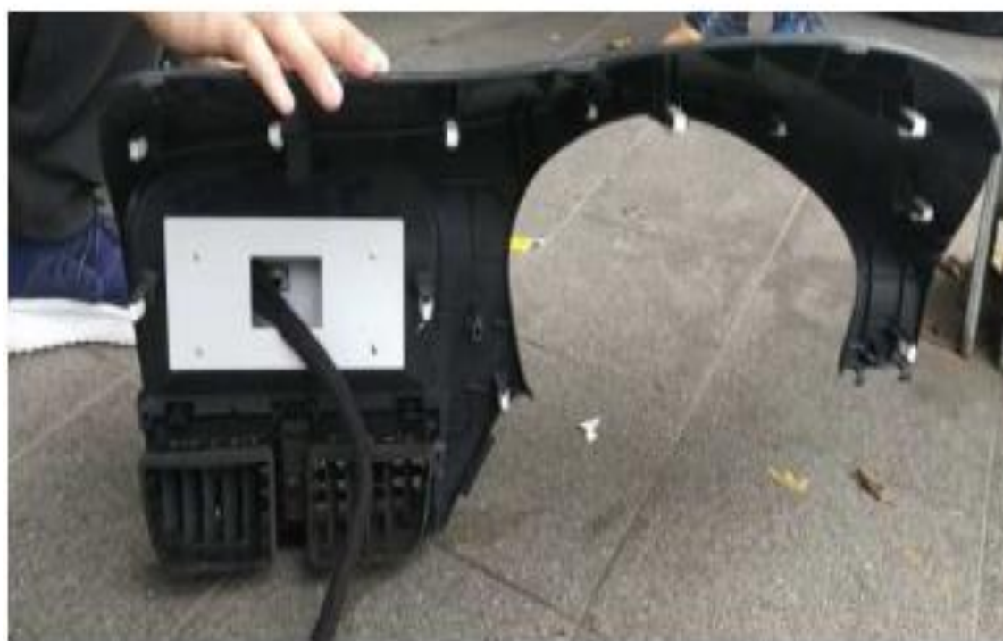
第 20 步大屏导航装在大框上背面效果图
