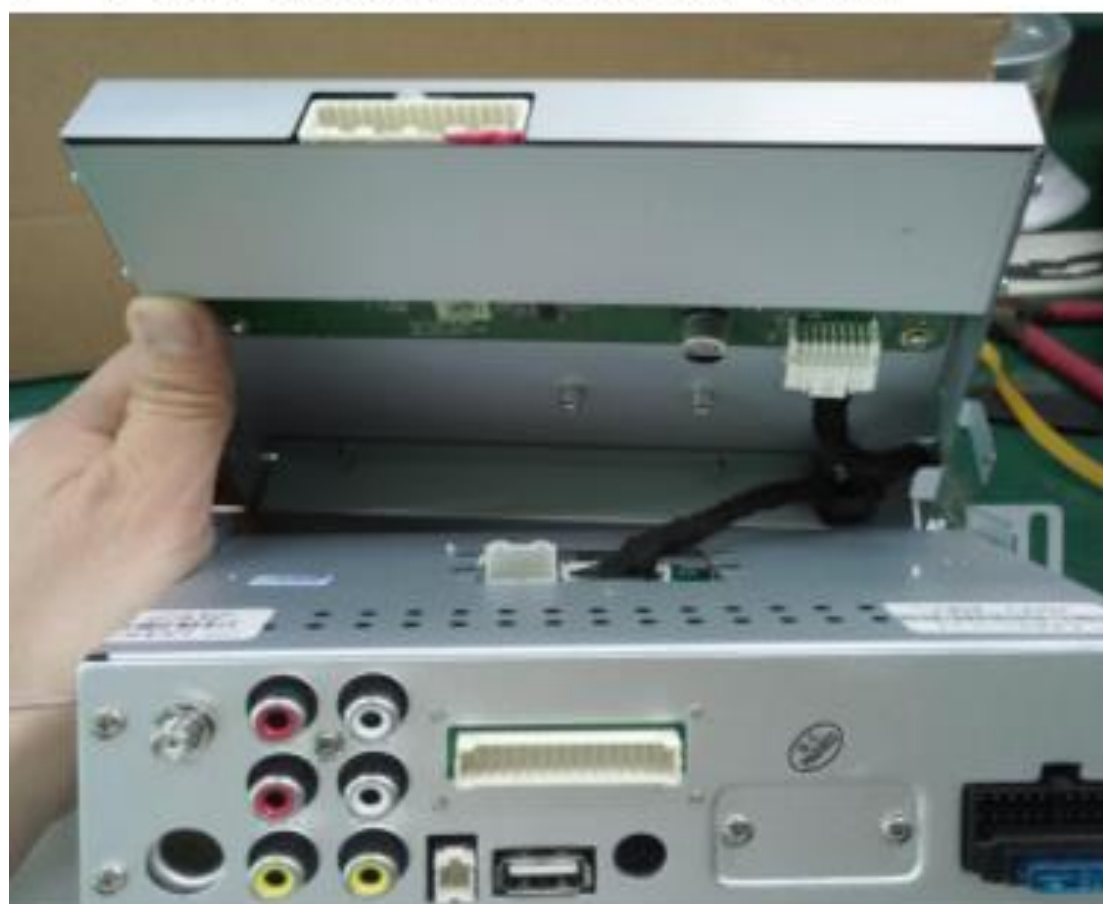
第 14 步把五金和大屏导航机箱锁在一起
